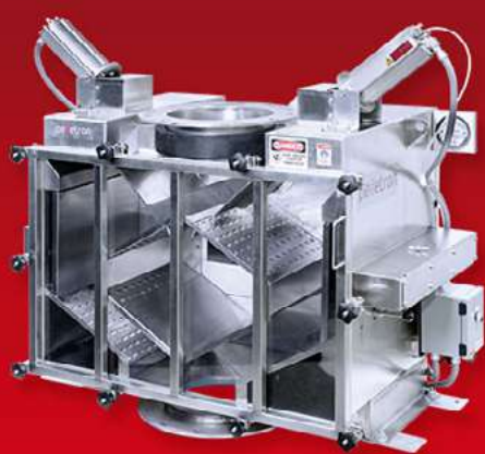
DeDuster®. El uso de XP180 a XP1500 automatiza los deflectores de entrada para la descarga del producto
