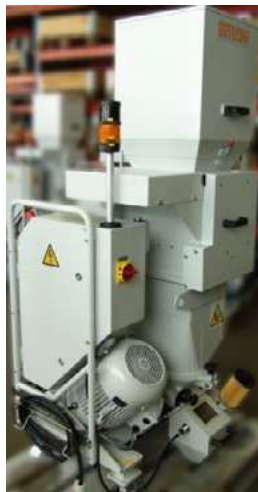
Diseño específico para el cliente: el molino de sala blanca GRS 180 con tolva de tajadera deslizante. (foto: Getecha).
