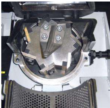
Una mirada al interior: cámara de corte abierta del molino de sala blanca GRS 180 con un diseño de protección contra el desgaste (por ejemplo, placas de desgaste bajo las cuchillas del rotor). Aquí puede verse claramente la junta tórica de la carcasa del molino (foto: Getecha).
