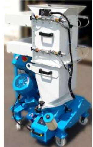
Pero hay más: El molino de sala limpia GRS 180 con diseño de doble tajadera. En este caso, la tolva de compuerta deslizante tiene dos correderas. (foto: Getecha)
