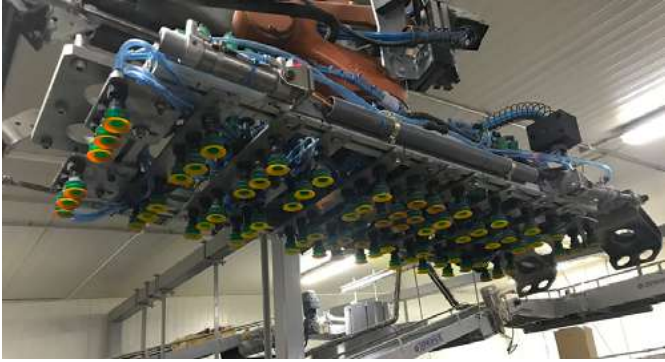
Garra de vacío formada por ventosas BX35P de Piab con tecnología de eyectores COAX®
