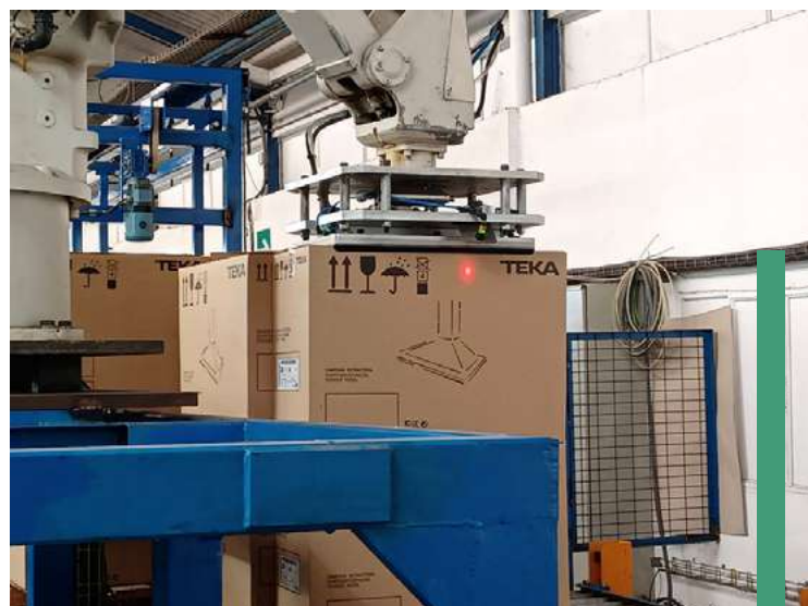
Robot manipulando una caja de gran formato con el plano aspirante Kenos® KVGL de Piab.
