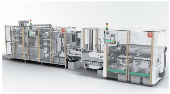
Monoblocco per il confezionamento di prodotti in blister con integrata la nuova astucciatrice alternata
