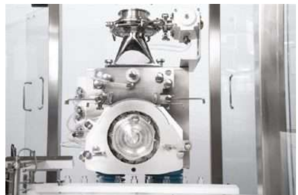
Dettaglio macchina riempimento polveri
